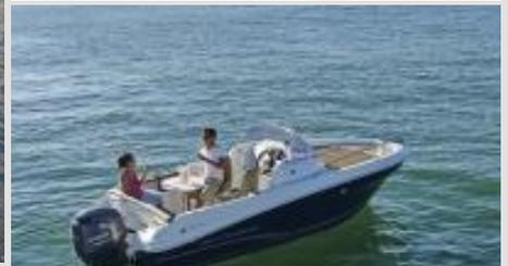
**Baujahr: 2019****Motor: Yamaha F100 FETL EFI (100 PS/Bleifrei)****Länge: 5,48 m****Breite: 2,36 m****Tiefgang: 0,50 m****Gewicht: 800 kg****Kraftstofftank: 100 l**
